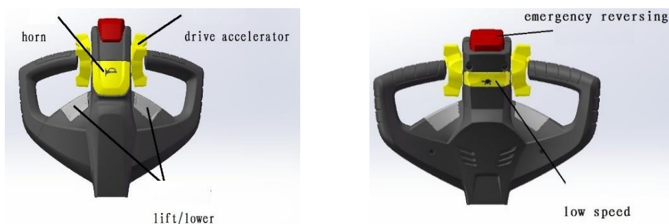
Рис.4 Horn – звуковой сигнал; drive accelerator – высокая скорость; lift/lower – кнопки управления «вверх» / «вниз»; drive acceleration – высокая скорость; Emergency reversing – кнопка аварийного обратного движения; low speed – медленная скорость.
